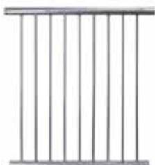
Die Geländerelemente können komplett im Interclamp System integriert werden. Mit dem Baukastensystem montieren Sie blitzschnell ein Sicherheitsgeländer. **Oberes und unteres Rohr aus 1.5" (48 mm)**, senkrechte Rohre Ø 12 mm, Abstand zwischen senkrechten Stäben 8 cm.
